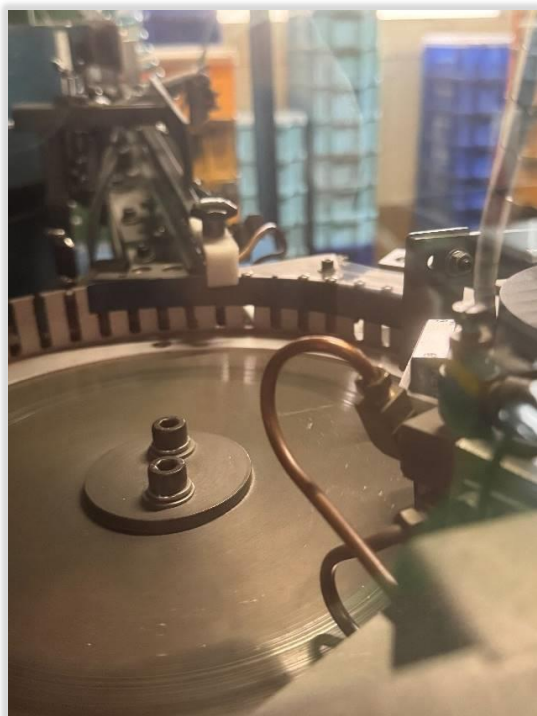
首下長さが短い製品も、櫛刃の回転盤に乗せて選別
