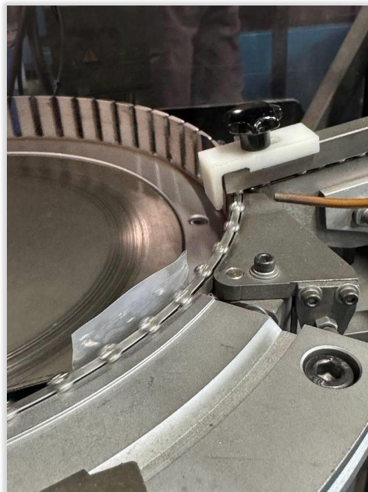
首下長さが短い製品も、櫛刃の回転盤に乗せて選別
