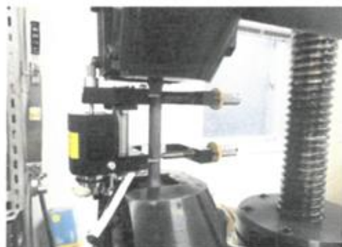
図2. 0.2%耐力測定、精密伸び計
