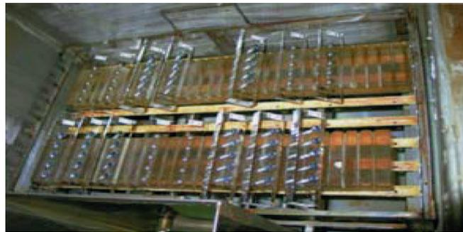
写真4 試験槽と試験片の設置状況
