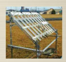
例えば FCK 法で加速試験し、15日で赤錆が発生するねじは、 大阪では 66ヶ月後、御前崎では12ヶ月後に赤錆が発生すると推定できる
