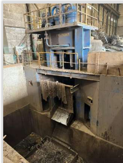
重機で分別された鉄類はギロチンにてカットされる
