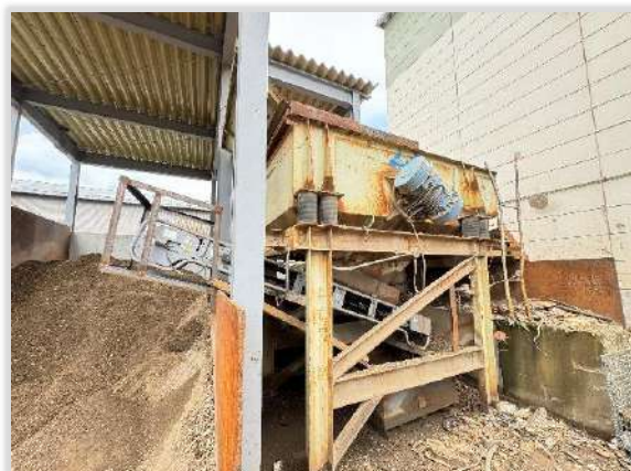
ギロチンでカットした時に出る小さな廃棄物と土。それを右の振動振るい装置で分類し、小さなものまで丁寧に分別してリサイクルされている。
