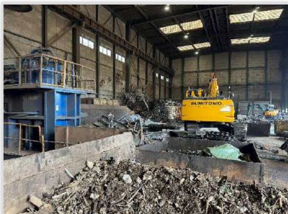
ギロチンでカットした時に出る小さな廃棄物と土。それを右の振動振るい装置で分類し、小さなものまで丁寧に分別してリサイクルされている。
