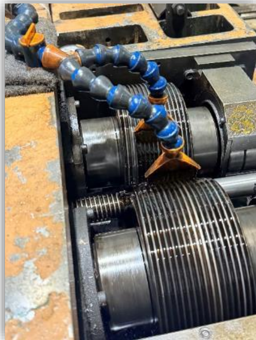
送り転造盤による長尺物の加工
