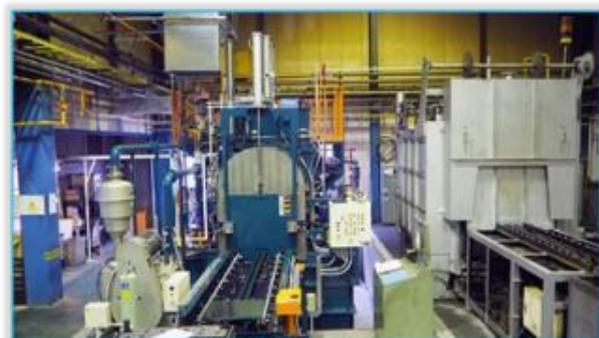
バッチ焼入焼戻し炉ライン 1基
