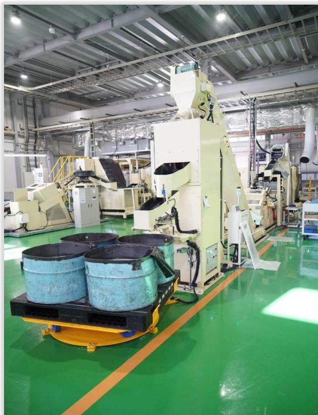
置。また、省人化対応にはボルトフォーマーとローリングマシンを自動コンベアで繋いだ次工程までの自動化システムが従来同様に取り入れている。新たな導入設備でみると、ローリングマシンからのワーク出口にある半ドラムが、一定数量の投入(収容)によって、次の空きドラムに入れ替わるドラムストッカーを採用。ドラムストッカーは回転式で、パレットを置き半ドラム4缶が並べられる仕様フォークリフトでの運搬を可能としている。
