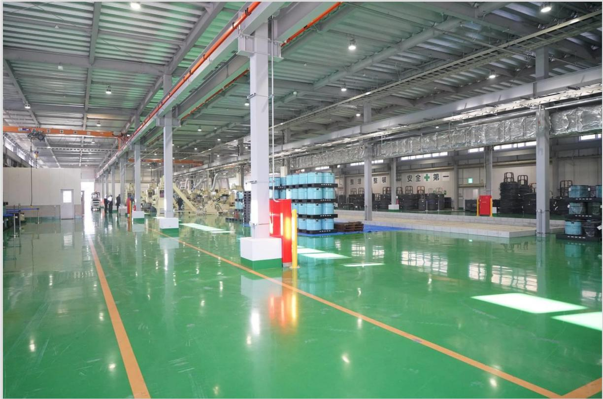
今回取材させて頂いて強く感じた事は、更地に一から工場を建てる事が出来る強み、動線を意識したレイアウト、材料搬入と製品出荷位置の構造。また、ボルトフォーマー・ローリングマシン・自動脱油機をライン化し、ワーク出口にある半ドラムが、一定数量投入されると次のドラムに入れ替わるドラムスタッカーの採用等省人化対応が徹底されていました。
