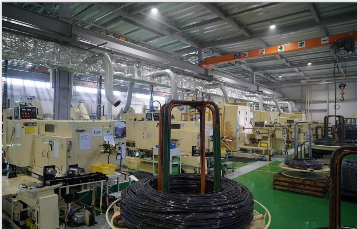
M4～M12の六角ボルト及び特殊冷間圧造部品を生産され、製造品目の内小径分野の拠点として、全生産量の30%を賅っているそうです。昨年12月時点では、ボルトフォーマー7台とローリング機7台によって操業中です。
