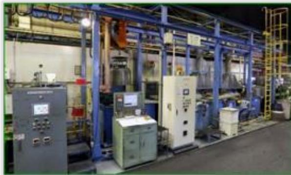
脱リン装置(ボンデ被膜除去)
